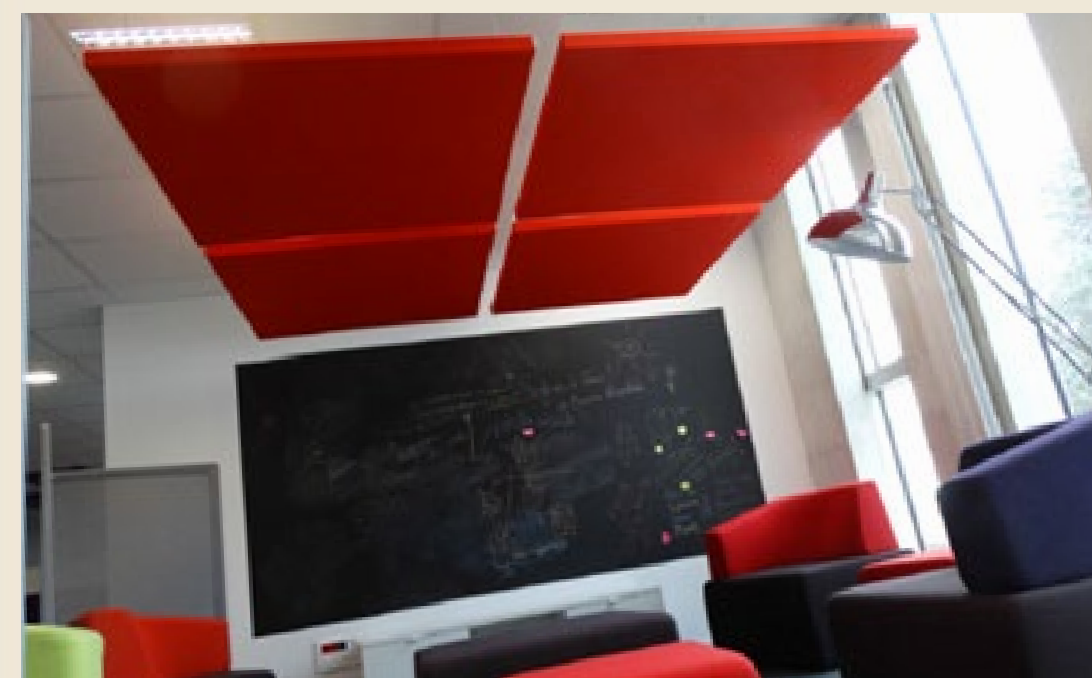
Des panneaux de laine de roche (Silencio design).
