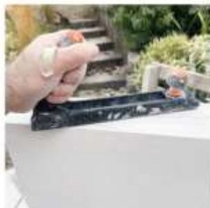
6 Si vous utilisez des caissons à emballement, sciez les languettes inutilisées : celles qui se trouveront sur le côté du meuble, par exemple. Rabotez-les pour obtenir une surface lisse.
